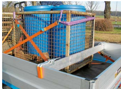
Flüssigkeiten in mobilen Tanks müssen formschlüssig mit dem Fahrzeug verbunden werden. Werden die Tanks in Gitterboxen transportiert, können sie auch durch direktes Verzurren gesichert werden.
